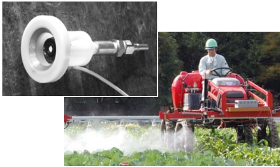
図1 ブームスプレーヤ型静電散布機と同一ノズル部
