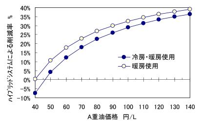
図1 重油価格変動によるハイブリッドシステムの冷暖房費削減率の変化
