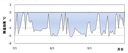
図2 改良型高圧細霧冷房装置による降温効果(9時~15時平均値、2010年7月~9月) 降温効果は、対照温室気温ー改良型高圧細霧冷房装置設置温室気温
