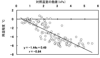
図3 改良型高圧細霧冷房装置による降温効果と対照温室飽差との関係(2010年7月~9月) 降温効果は、対照温室気温ー改良型高圧細霧冷房装置設置温室気温
