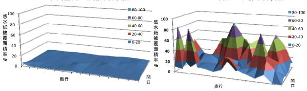
図1 改良型高圧細霧冷房装置および細霧冷房装置で115㎡の密閉温室内に32.2mL/㎡散水後の感水紙被覆面積率(面積115.2㎡ 間口6.4m×奥行18mの密閉温室で測定)
