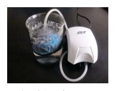
図 1 水浸漬およびエアレー ション処理の方法
