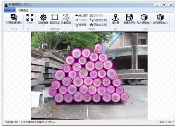
図1 原木材積計測システム
