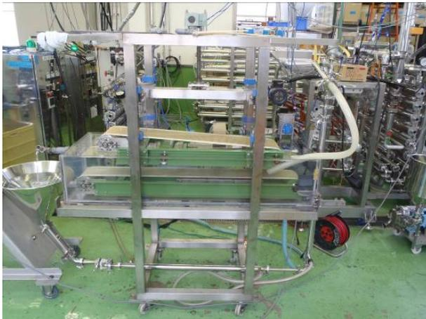
写真1 開発した連続式通電加熱装置
