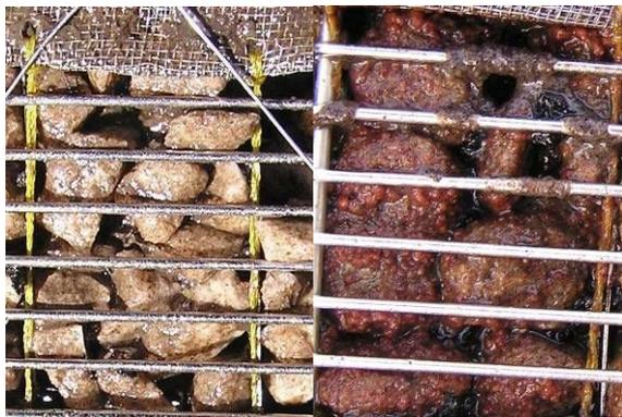
図1 ガラス発泡担体に集積されたアナモックスバイオフィルム (H27)
