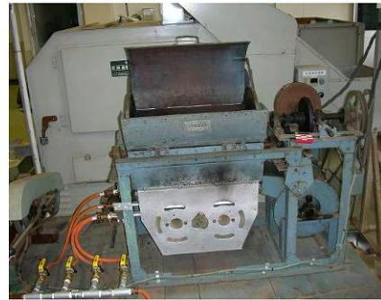
写真1 試験に用いた1k型炒り葉機
