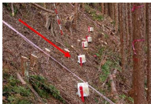
写真4 斜面に設置した土砂受け箱
