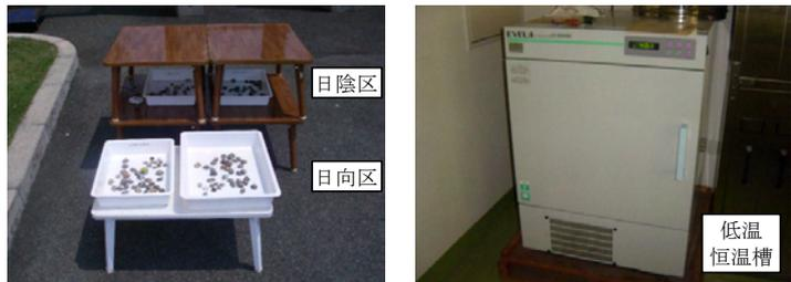
図6 空中暴露試験の様子
