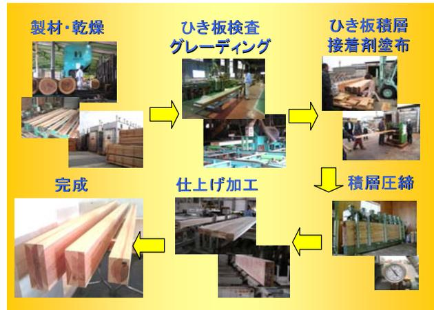
図4 積層接着合わせ梁の製造工程
