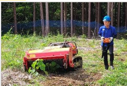
リモコン式草刈り機を活用した下刈りの機械化実証 (静岡県東部地域デジタル林業推進コンソーシアム)
