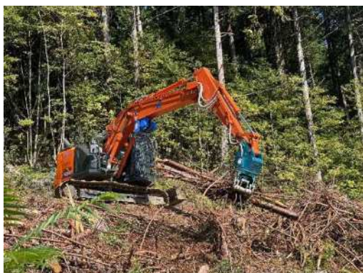
フォワーダーによる林地残材の小運搬
