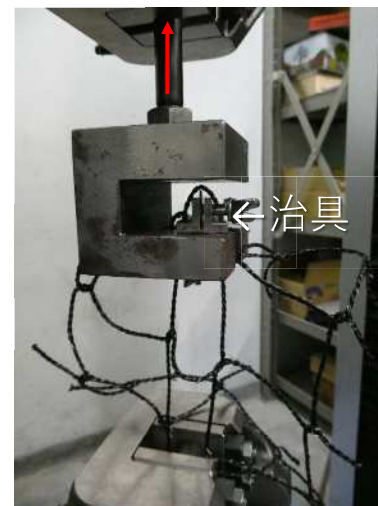
(B) 引張切断試験
