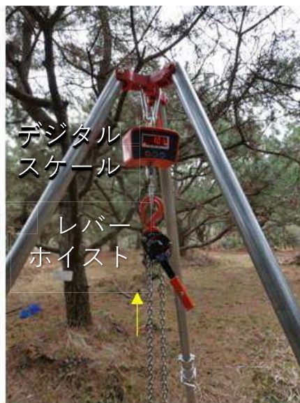
引き上げ荷重
