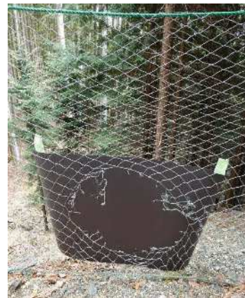
軟質ステンレス鋼線入り ネットの動物による切断
