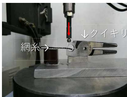
(A) 押切切断試験
