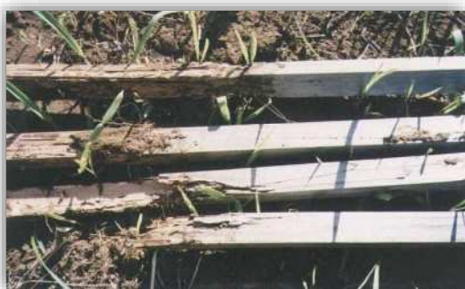
【無処理材】 1年で腐朽
