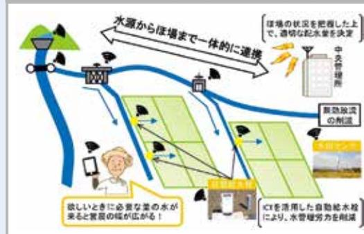
I C T を活用して土地改良区及び水田農家の水管理を省力化・効率化し、高度な需給調整により経営戦略に基づく弾力的な水利用を可能とします。
