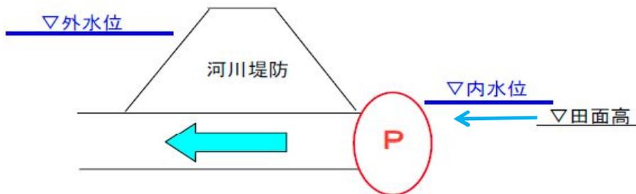
河川に囲まれた低平地では、大雨時には自然排水されず、排水ポンプ等により、強制排水を行います
