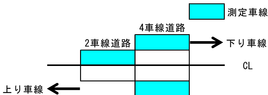
図解-3.2 路面性状調査の測定車線
