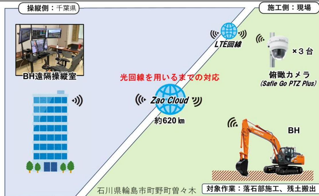
遠隔操縦概要図 ((株)大林組提供)
