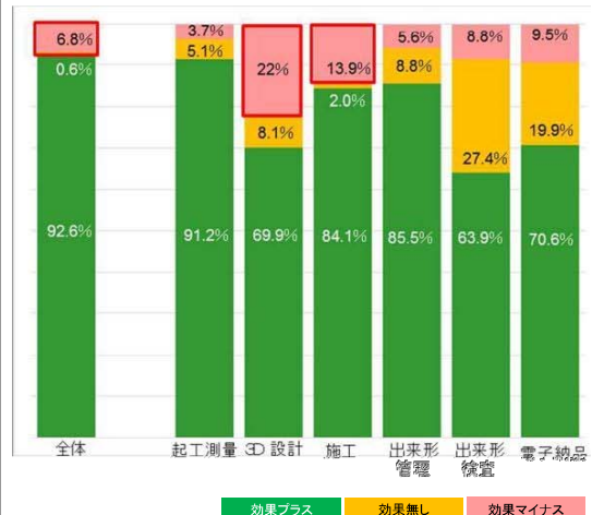
ICT施工による延べ作業時間の縮減効果が得られた工事の割合（利用場面別）
