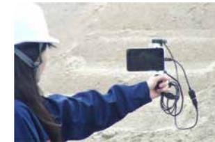
GNSSを用いた写真測量技術
