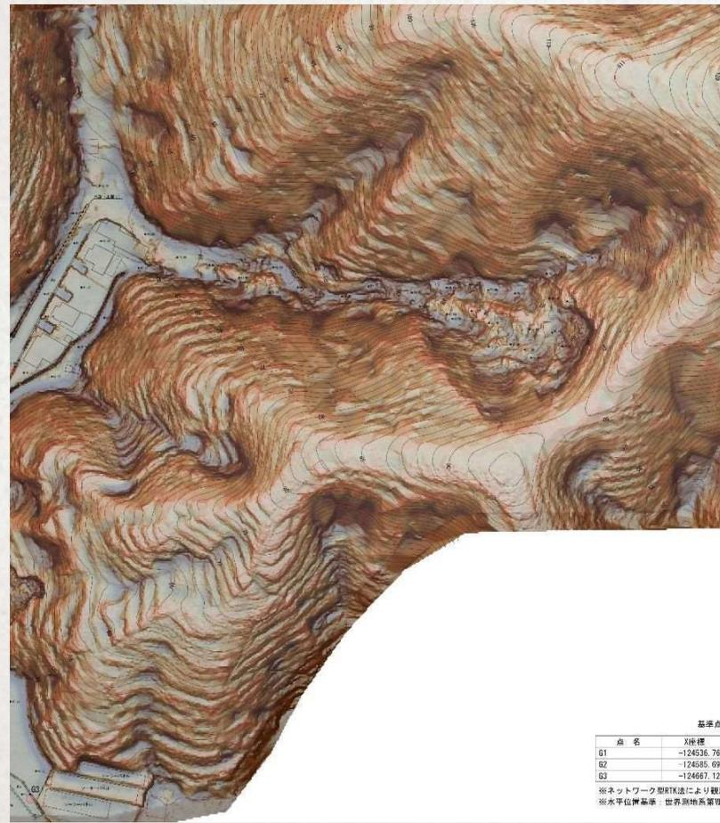
UAVレーザデータより作成した陰影図を背景にした現況がわかりやすい平面図
