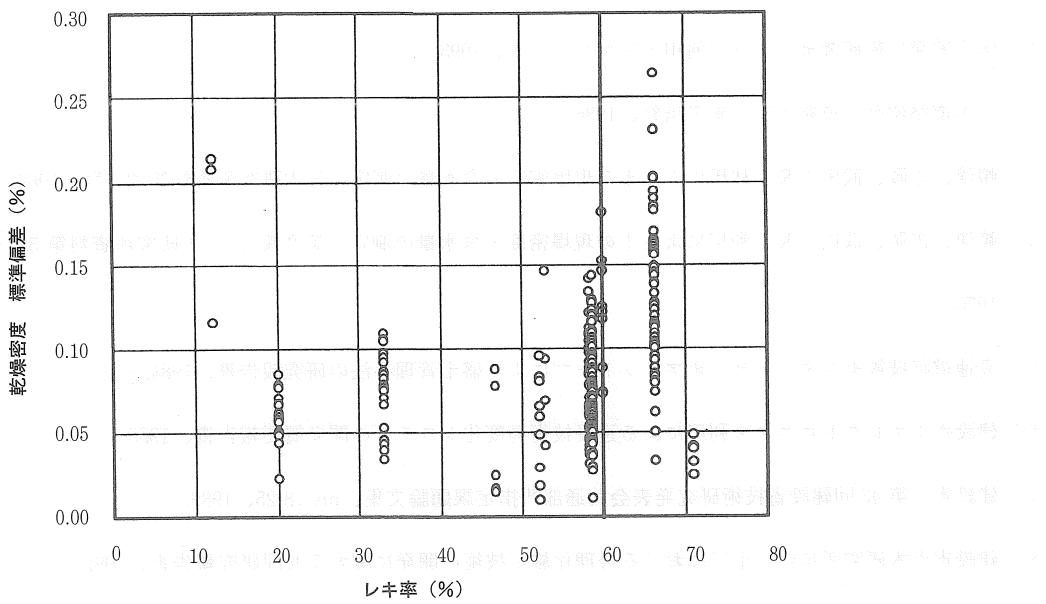
図-13 レキ率と乾燥密度（標準偏差）の関係 [散乱型]
