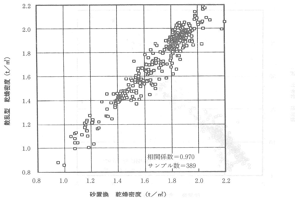
図-1 砂置換と散乱型の相関（乾燥密度・全データ）
