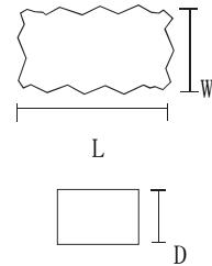
※厚さは普通および透水性インターロッキングブロックの場合60mmおよび80mmとし、植生用インターロッキングブロックの場合100mmおよび120mmとする。
