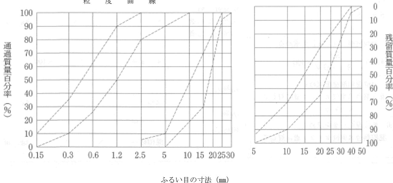
注 ふるいの呼び寸法は、それぞれ JIS Z8801 に規定する網ふるい 53mm、37.5mm、31.5mm、26.5mm、19mm、16mm、9.5mm、4.75 mm、2.36mm、1.18 mm、600 μm、300 μm、及び 150 μm である。
