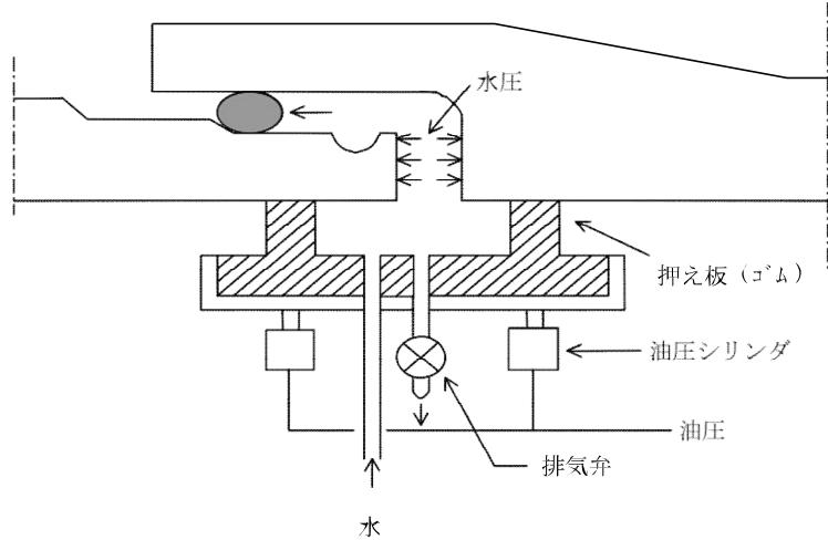
図-3 テストバンドの機構の概略
