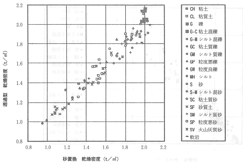
図-6 砂置換と透過型の相関（乾燥密度・土質別データ）
