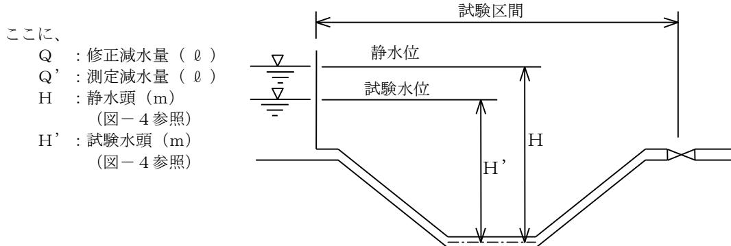
図-4 試験水頭のとり方
