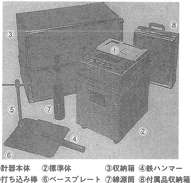
図一 4 計器の構成例（透過型）
