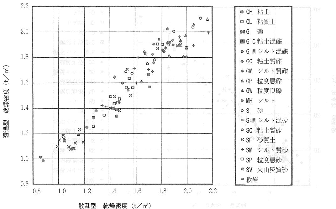
図-10 散乱型と透過型の相関(乾燥密度・土質別データ)
