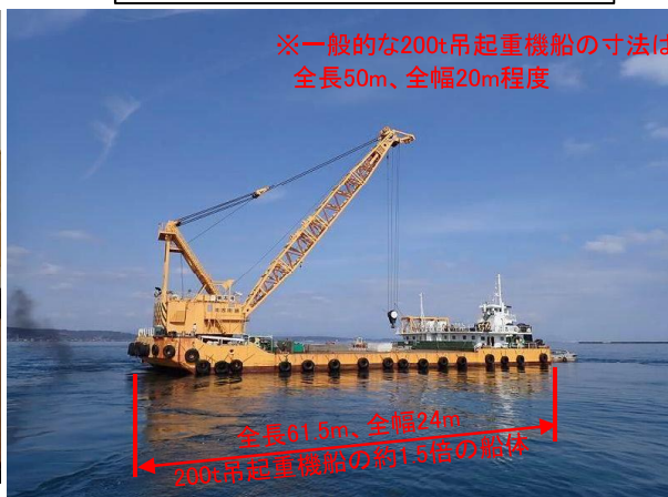
②400t吊 大型重機船の使用
