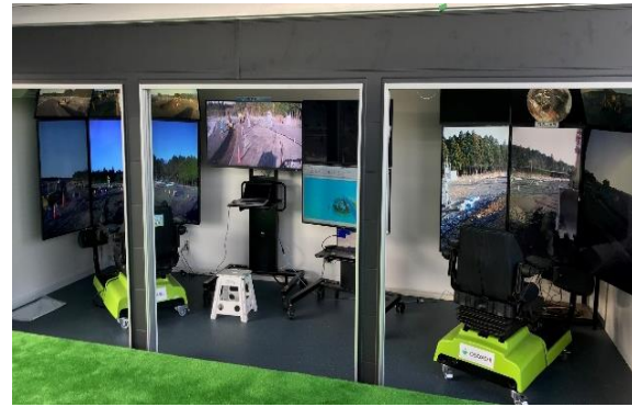
大阪府から重機を遠隔操作 (操作室の様子)
