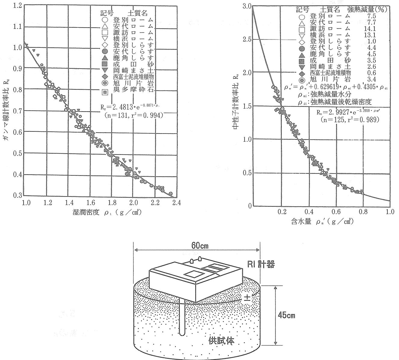
図-3 計数率比と湿潤密度および含水量の検定例
