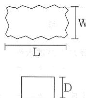
※厚さは普通および透水性インターロッキングブロックの場合 60mmおよび 80mmとし、植生用インターロッキングブロックの場合 100mmおよび 120mmとする。
