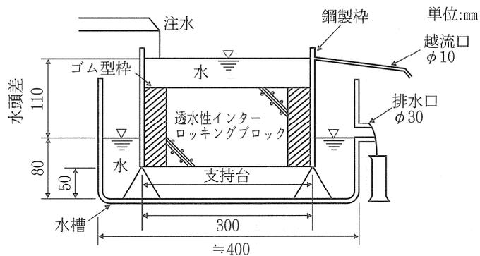
図3 透水試験装置の概略図
