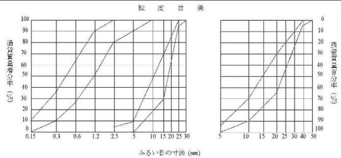
注: ふるいの呼び寸法は、それぞれJIS Z 8801に規定する細ふるい53mm、37.5mm、31.5mm、26.5mm、19mm、16mm、9.5mm、4.75mm、2.36mm、1.18mm、600μ、300μ、及び150μである。
