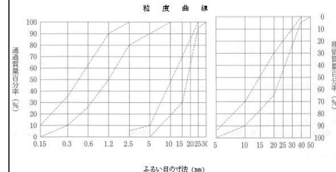
注: ふるいの呼び寸法は、それぞれJIS Z 8801に規定する細ふるい53mm、37.5mm、31.5mm、26.5mm、19mm、16mm、9.5mm、4.75mm、2.36mm、1.18mm、600μ、300μ、及び150μである。
