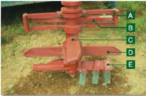
(A)スローピッチ翼 (B)ハイピッチ翼 (C)第一攪拌翼 (D)共回り防止翼 (E)掘削翼
