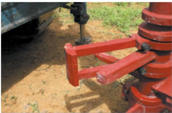
第一攪拌翼で切りほぐした土より細かく細断する。
