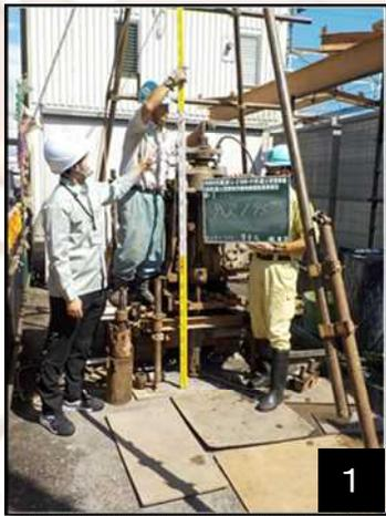
① はじめに**標準貫入試験※**を行い、地盤の硬さ、軟らかさ、試料の採取、地盤の締め具合を調べます。所定の深さまで掘削するので、硬い地盤であれば打撃しても、貫入しにくく、軟らかい地盤であれば簡単に貫入します。
