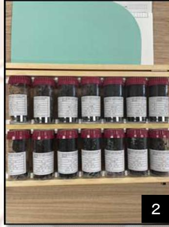
② サンプルを採取し、土粒子の密度、含水比、粒度、等を調べます。土粒子の密度が高ければ硬く、含水比が高ければ柔らかい地層だということが分かります。
