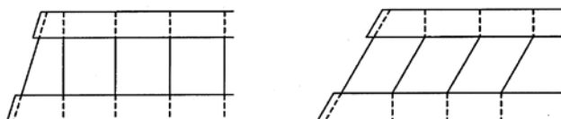
図 6-2 横桁の配置方向
