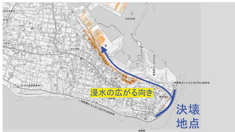
海岸堤防決壊ありのケースと海岸堤防決壊なしのケースの比較 (着色部: 決壊なしの浸水区域 - 決壊ありの浸水区域)
