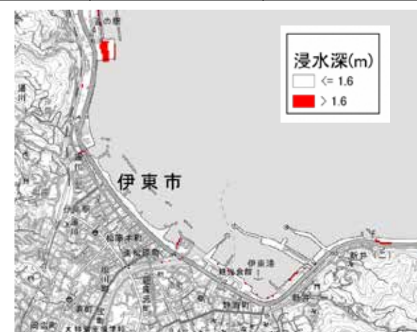
津波氾濫による家屋倒壊条件
