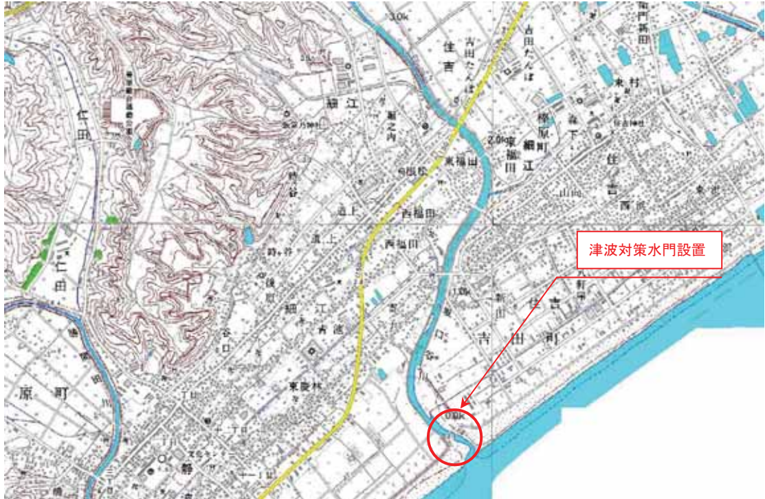
図 4-4 津波対策水門の設置箇所
