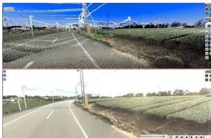
■取得データ（右画像） （上段：三次元点群データ） （下段：6方向カメラ映像）
