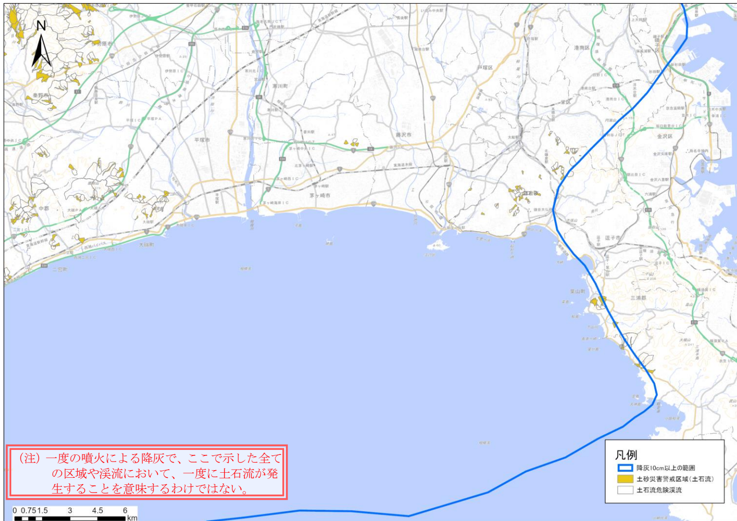
図 3-5 降灰後土石流の可能性マップ 神奈川県横須賀三浦地域及び湘南地域周辺
