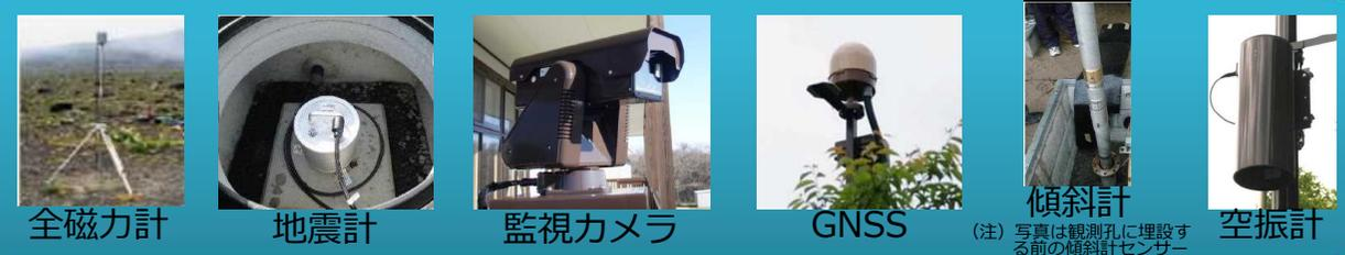
（注）写真は観測孔に埋設する前の傾斜計センサー
