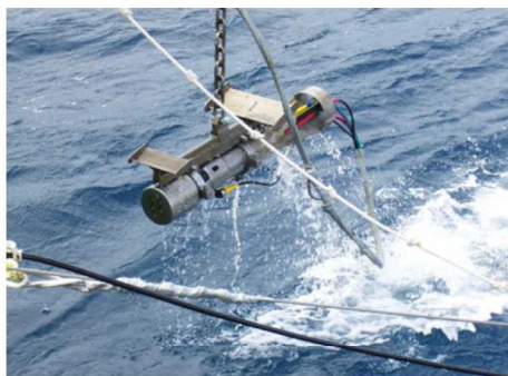
Air gun エアガン（深海の構造探査で使用） 通常使用する周波数帯域: 8Hz~80Hz
