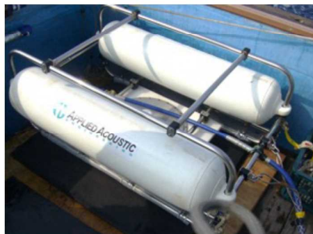
Boomer ブーマー（浅海の高解像探査で使用） 周波数帯域: 1kHz~
