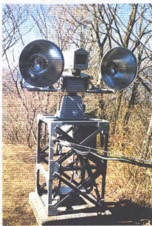
土石流監視カメラ
