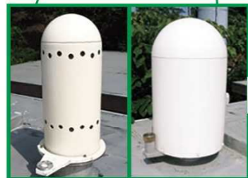
(図1) NaIシンチレーション式検出器 低いレベルの放射線を測定 (図2) 電離箱式検出器 高いレベルの放射線を測定
