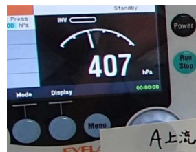
図2 下流側ニードルバルブ操作時の捕集カラム1段目付近圧力
