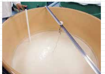
貯蔵タンクはセンサーで温度管理
