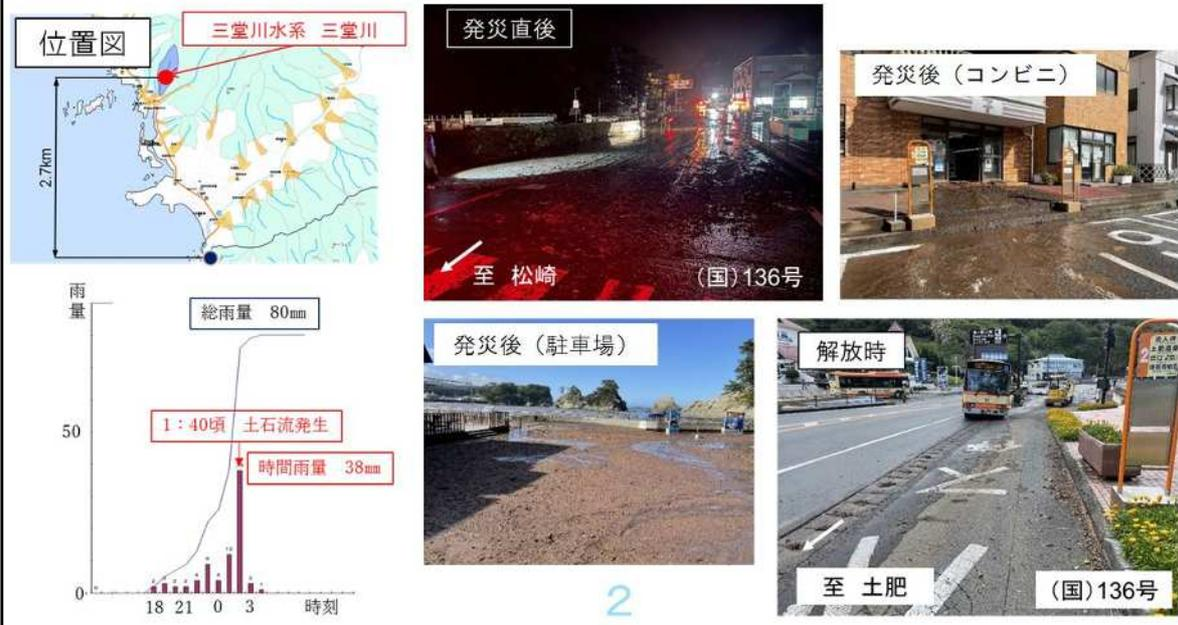
近年の災害発生状況は、長く降り続いた降雨の後の1時間あたり降雨量が30mmを超えるような降り方の場合に、崩土や法面の崩壊が発生するような場合が多いように感じる。
