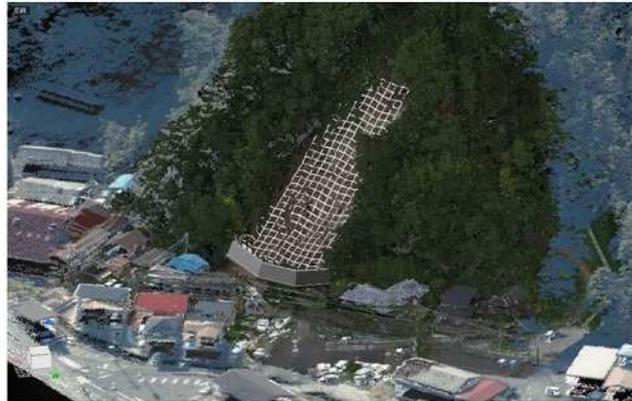
こちらは、3次元点群データで取得した崩壊斜面に、復旧工法である吹付け法枠工及び重力式擁壁工の点群データを重ねた対策後の状況を示したもの。あらゆる角度から対策後の状況が確認できるため、今後の地元説明会等で使用し、完成後のイメージを住民の方に持って頂き事業を進めていく予定。
