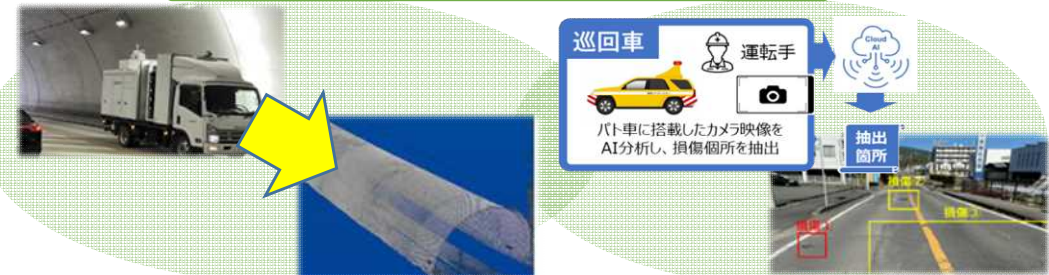
●3DデータとAI分析によるトンネル点検
