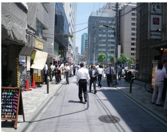
2-A 同一路内をインターロッキング舗装に統一し、色と模様で変化を持たせ歩車道の区分をしている。（静岡市）
