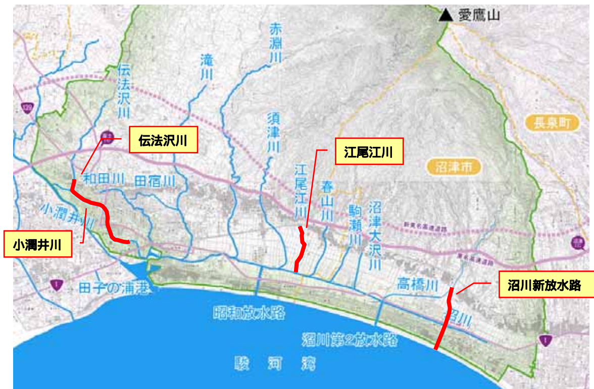
図 4.1 河川整備計画の主な整備箇所
