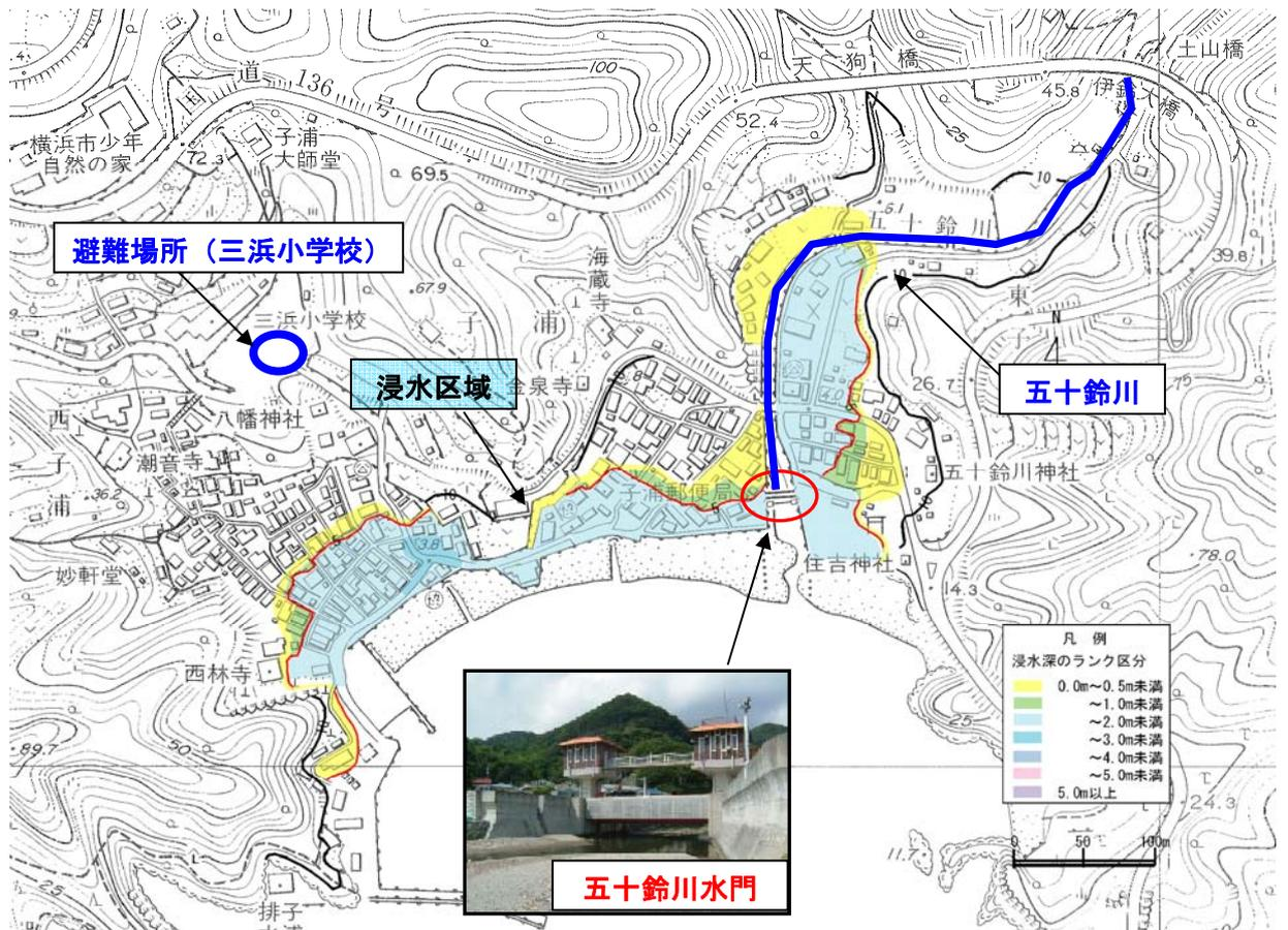
東子浦地区の津波による2次想定浸水区域図 (津波高 TP. +6.0m レベル湛水)
