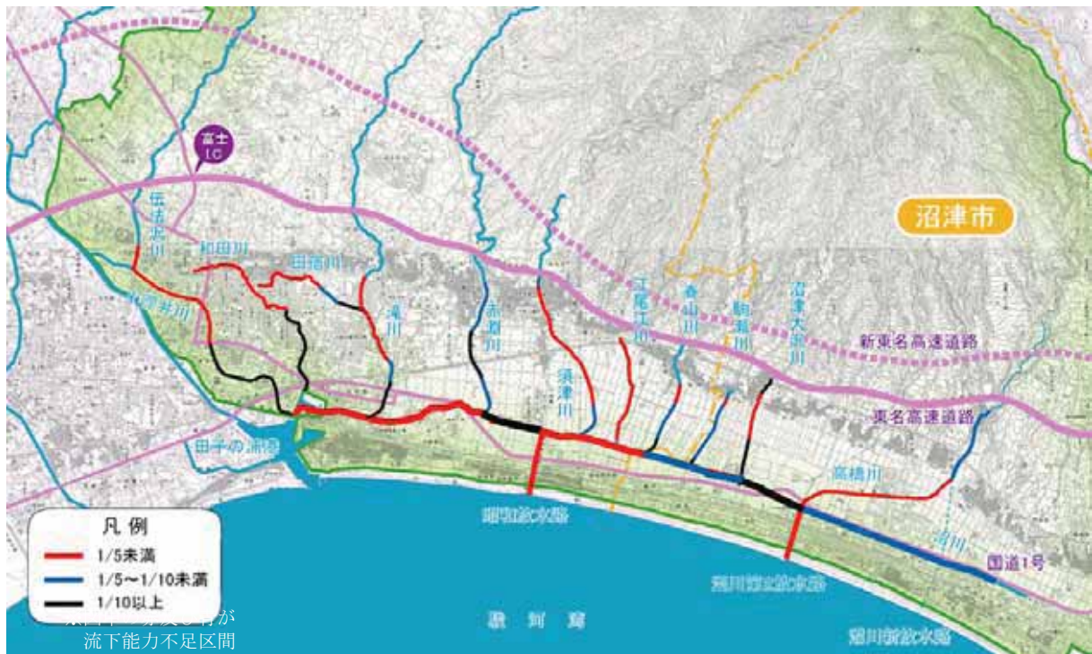
(参考) 図 3. 1 1/10 基本高水に対する流下能力不足区間
