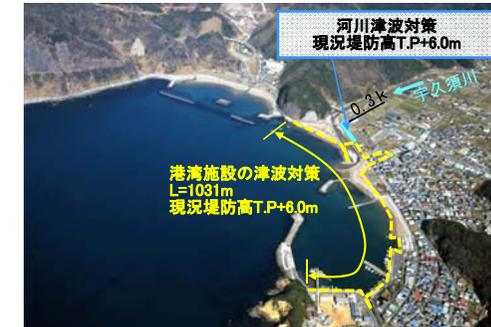
図 津波対策施設の整備状況(宇久須川)
