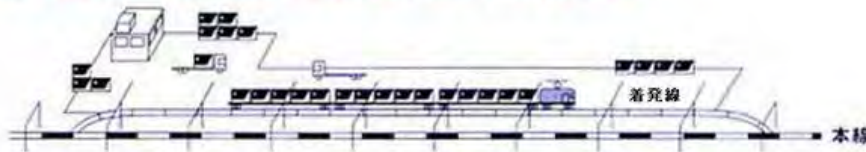
◎着発線荷役方式(単純な配線と短時間で済む荷役作業)
