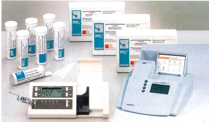
図 小型反射式光度計の種類 (左がRQフレックス、右がRQ-NOVA)
