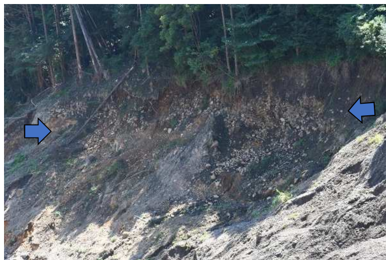
写真⑦ 逢初川右岸斜面（崩落地南壁）にみられる斜面堆積物 2
