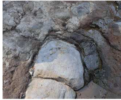
写真⑧ 風化・変質を受けていない比較的堅固な安山岩（砂防堰堤よりも下流の溪床）
