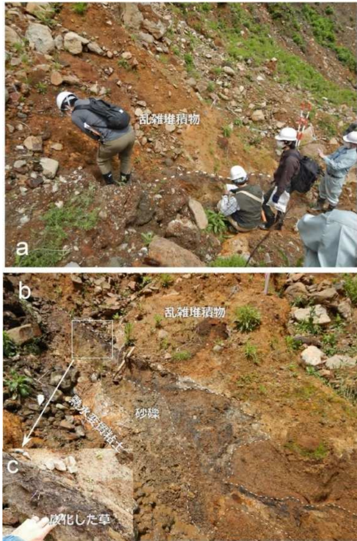
図 3-10 上図(a)：乱雑堆積物（黄褐色部）。表面には崩壊土石が載っている。 破線はその下底面。
