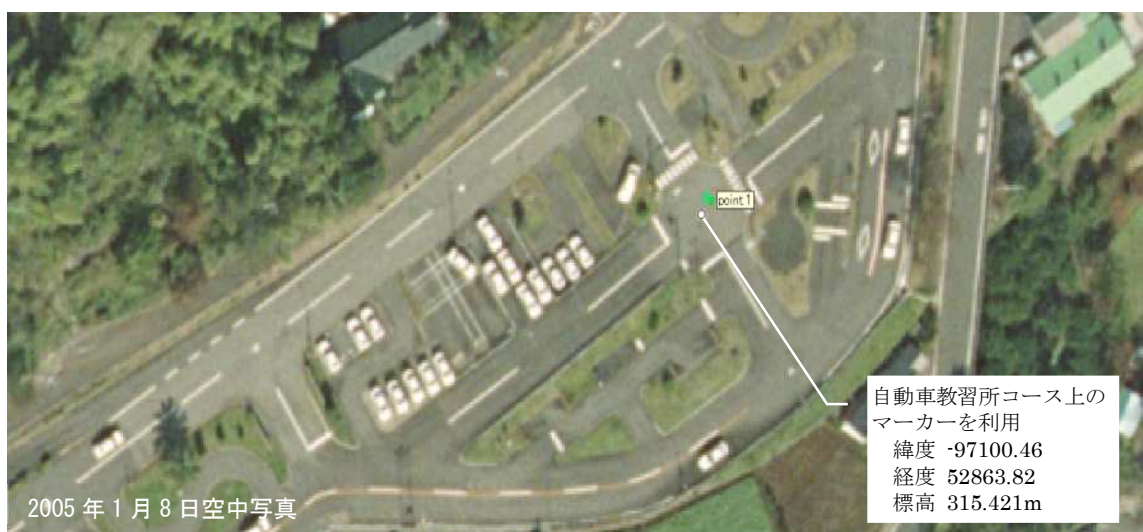
図 3-12 GCP の設置例
